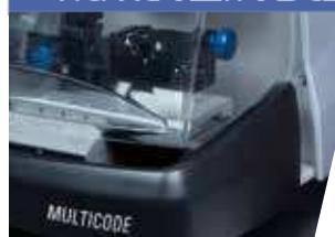
La pantalla protectora y la bandeja para recoger virutas bloquean el funcionamiento de la máquina mientras están abiertas.
